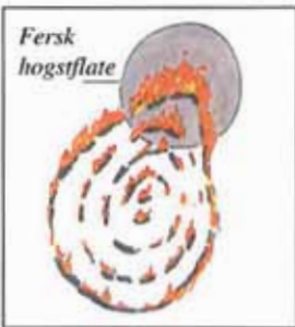
Varmesugets virkning på brannforløpet.
